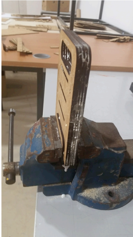
Abbildung 12: Leim tritt aus dem Griff aus
