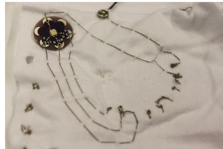
Abbildung 7: Die eingenähte RGB-LED
