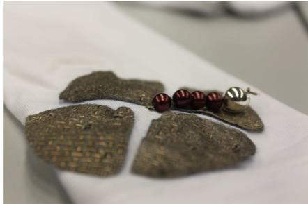
Abbildung 8: Der Neigungssensor mit vier Richtungen
